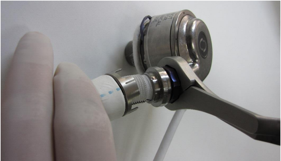
Abbildung 16 - Vollständiges Greifen der ausgerichteten Backen in das Profil der Schelle
