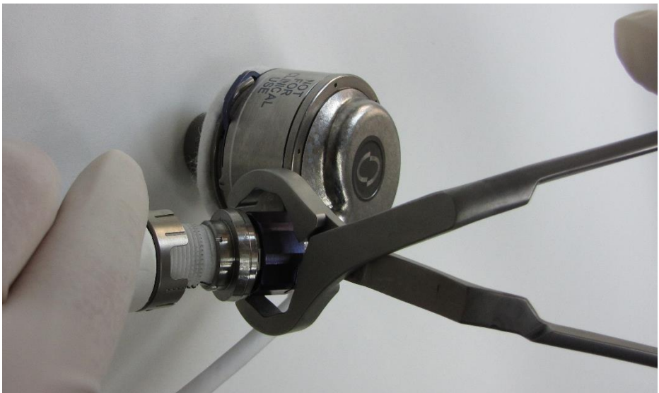
Abbildung 15 - A2 Öffnen der Backen und Greifen der Schelle
