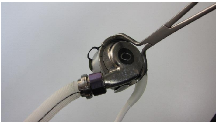
Abbildung 6 - A2 Festes Greifen des Objekts ohne Kollision
