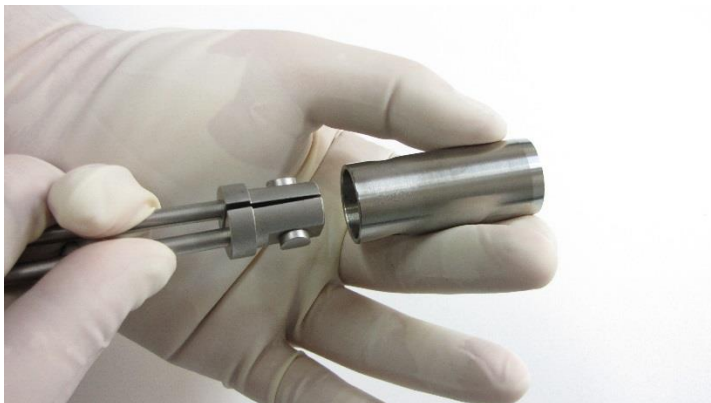
Obrázek 12 - A2 Nasadíte hrotový nůž na úchyt nástavce
