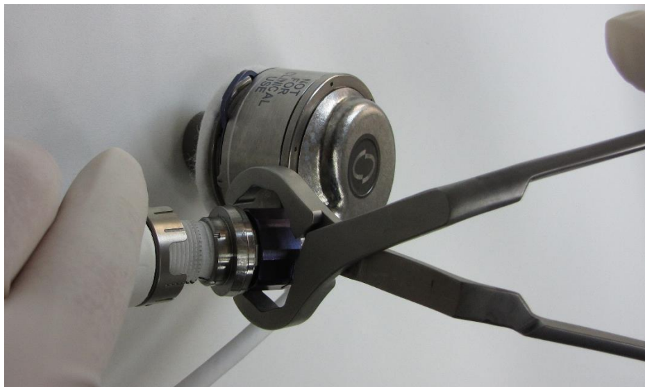
Obrázek 15 - A2 rozevření čelistí a uchycení objímky
