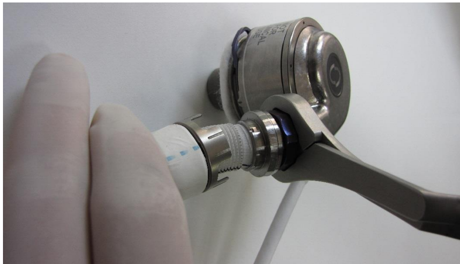
Obrázek 16 - Plné uchycení zarovnaných čelistí do profilu objímky
